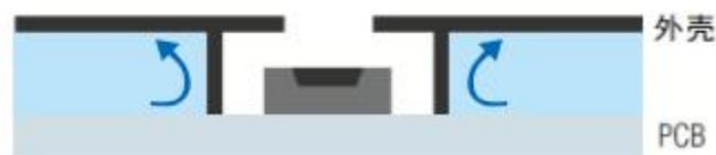
图2:传感器与外壳内部死区空气完全隔离，最大限度地减少了外壳内部密闭空气对传感器的影响
